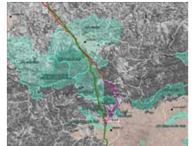
Travessia APAs de Jundiá e de Cajamar. Traçado Projeto Uniduto (vermelho) previa implantação nas faixas de domínio da rodovia dos Bandeirantes. Projeto Logum Trecho Paulínia-RMSP-Santos (verde) utilizará a faixa de dutos do OPASA (diretriz Petrobras), evitando novas intervenções nas duas APAs.
