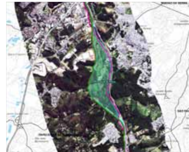
Trecho da várzea do rio Embu-Guaçu, onde estão previstas unidades de conservação em Embu das Artes e Itapeverica da Serra. As propostas "diretriz Projeto Uniduto" (linha cor magenta) e Projeto Logum Trecho Paulínia-RMSP-Santos (linha verde) se dão pelas pistas opostas do Rodoanel - trecho sul.
