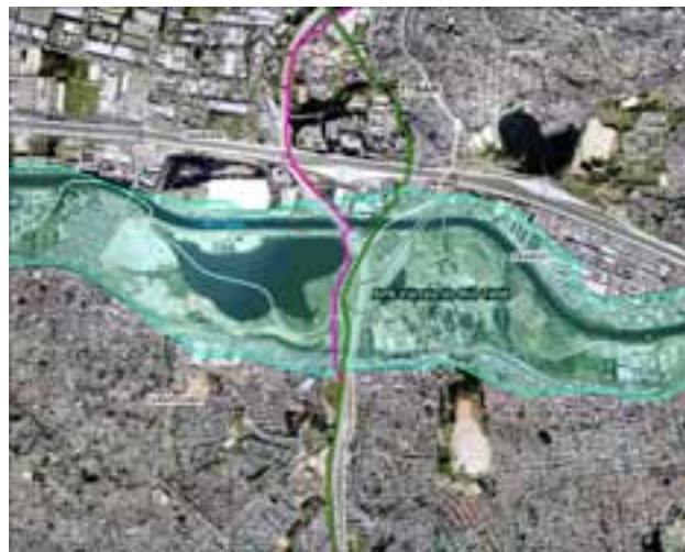
Travessia da rodovia Castello Branco e do rio Tietê, considerando a diretriz "Projeto Uniduto" (linha cor magenta) e o traçado Projeto Logum Trecho Paulínia-RMSP-Santos (linha verde).
