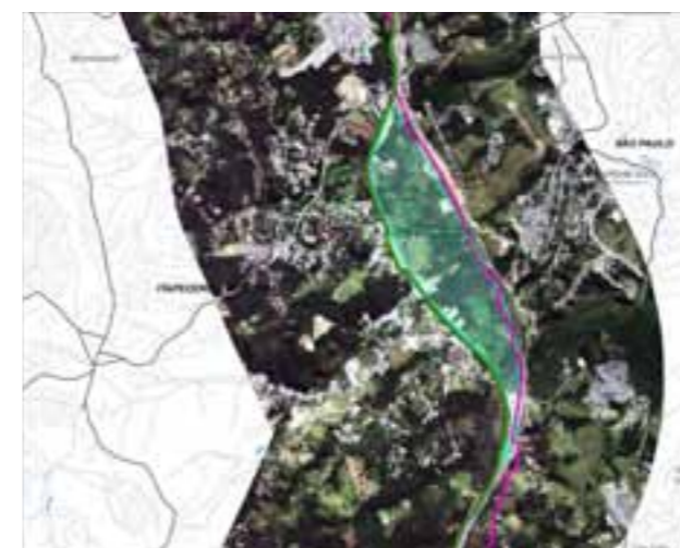
Trecho da várzea do rio Embu-Guaçu, na altura do município de Itapeverica da Serra. As propostas "diretriz Projeto Uniduto" (linha cor magenta) e Projeto Logum Trecho Paulínia-RMSP-Santos (linha verde) se dão pelas pistas opostas do Rodoanel - trecho sul.
