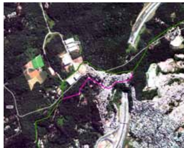
Trecho de transposição da rodovia Regis Bittencourt. A diretriz "Projeto Uniduto" (linha cor magenta) e o traçado Projeto Logum Trecho Paulínia-RMSP-Santos (linha verde) preveem a passagem pela comunidade existente, mas por caminhos distintos.
