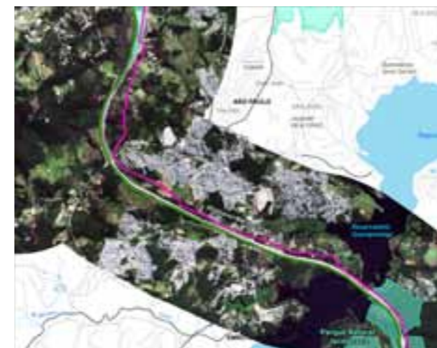
Trecho do Rodoanel sul em Itapeverica da Serra. Enquanto a diretriz "Projeto Uniduto" (linha cor magenta) contemplava a saída da faixa de domínio, o traçado Projeto Logum Trecho Paulínia-RMSP-Santos (linha verde) se manteve na faixa de domínio, após avaliação das condições de construtibilidade pela equipe de engenharia da Logum.
